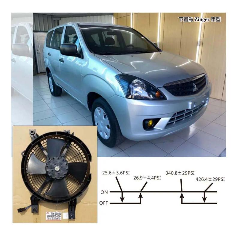
上左圖 Zinger 一代二代冷氣風扇的示意圖,舊 Zinger 只有冷氣系統風扇為電子式的,引擎系統的散熱風扇還是採用傳統機械式的風扇離合器,因此還是有可能出現矽油老化,導致風扇空轉,讓引擎溫度升高。
