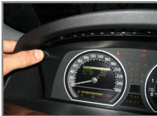
注意：當超過所規定的公里數或日期時，LCD中央顯示區會顯示保養資訊，且進行儀錶歸零時，歸零主功能表會顯示“！”提醒字樣。如前剎車片更換時間超過或未作歸零時，會顯示“Fr.brake 40Tkm！”
